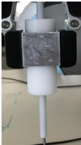
2. ábra Általunk tervezett és gyártott rúgós erőmérő eszköz
