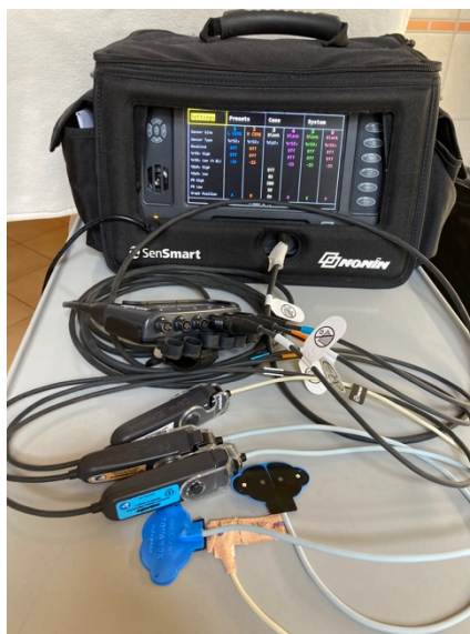
2. ábra: NIRS monitor újszülött szenzorral (SenSmart ®Model X-100, Nonin Medical Inc., saját felvétel)
