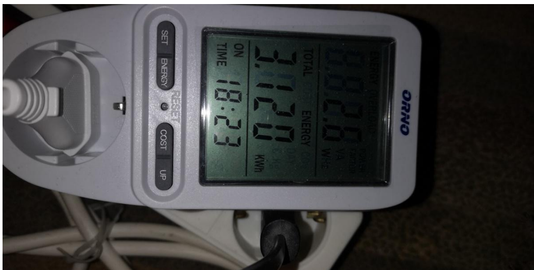
5. ábra: A 10-es felhasználónál elhelyezett az elfogyasztott villamos energia mennyiség mérésére szolgáló fogyasztásmérő az utolsó vizsgálati napon (SAVE PU10)
