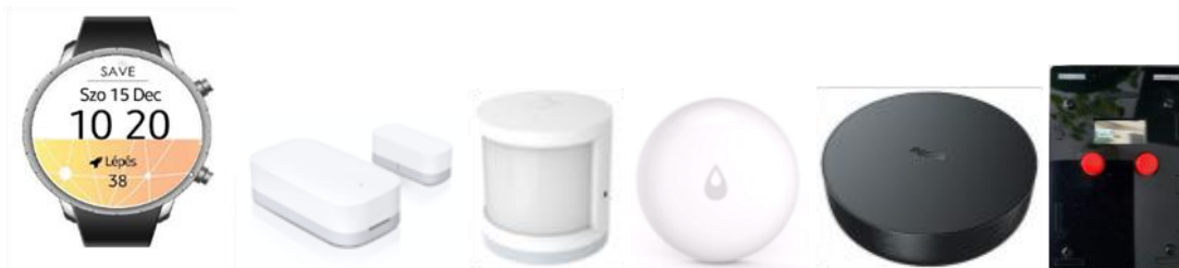
2. ábra: Balról jobbra: a SAVE applikációt futtató okosóra (pulzus, lépésszám, helymeghatározás), ajtónyitás érzékelő, mozgásérzékelő, vízfolyás érzékelő, Aqara szenzorkészlet központi egysége, Vision Systems szenzor adatgyűjtő
